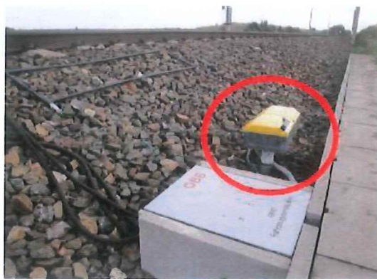
Obr. č.7 Příklady umístění identifikačních prvků RFID na vozidle a v kolejišti [10]
