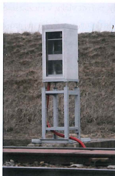
Obr. č.8 Zařízení StarCam pro optické čtení čísel železničních vozidel
